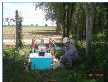
ภาพที่ 3.8 ภาพแสดงการเก็บตัวอย่างคุณภาพน้ำใต้ดิน
