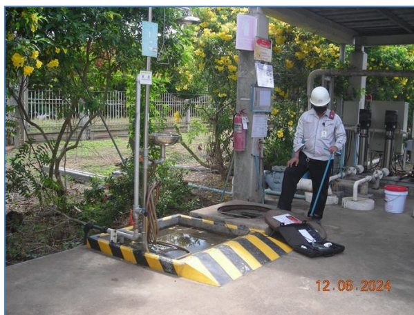
ภาพที่ 3.7 ภาพแสดงการเก็บตัวอย่างคุณภาพน้ำในบ่อน้ำทิ้ง
