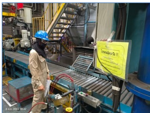
ภาพที่ 3.17.1 ภาพแสดงการตรวจวัดระดับเสียงในพื้นที่ทำงาน
