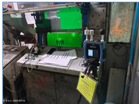
ภาพที่ 3.15 ภาพแสดงการตรวจวัดระดับความร้อนภายในพื้นที่ทำงาน
