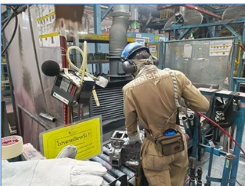
ภาพที่ 3.13 ภาพแสดงการเก็บตัวอย่างฝุ่นละอองในอากาศภายในพื้นที่ทำงาน
