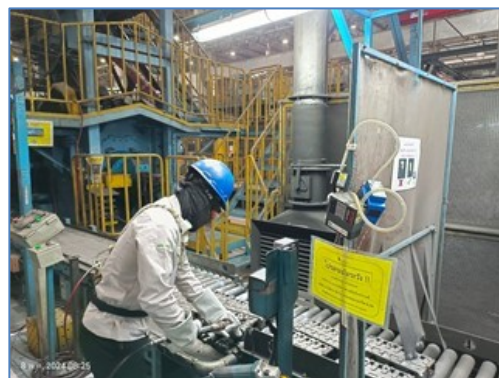
ภาพที่ 3.13 ภาพแสดงการเก็บตัวอย่างฝุ่นละอองในอากาศภายในพื้นที่ทำงาน
