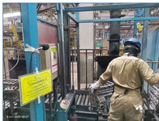
ภาพที่ 3.17.1 ภาพแสดงการตรวจวัดระดับเสียงในพื้นที่ทำงาน
